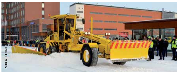
Veekmas Oy:n tiehöylä FG 2327 S, puskulevyn, lumistopparin ja sivuauran kanssa, diplomi.
